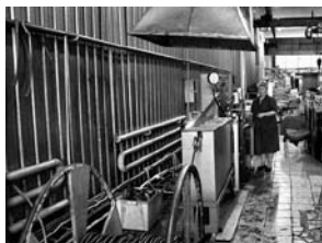
Рис. 11. Линии по непрерывному раздуву труб
