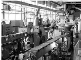
Рис. 4. Линии по экструзии труб
